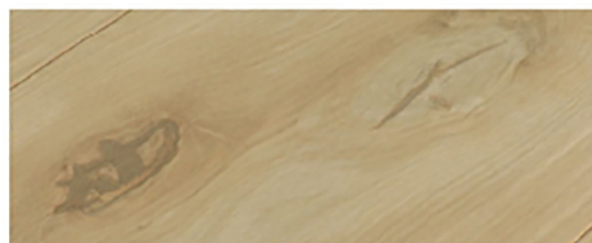
Паркетная доска с дефектом, заделанным Новорит-Фортэ, после шлифования
